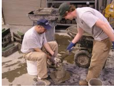
Resim 1.1: Numunenin huniye doldurulması
