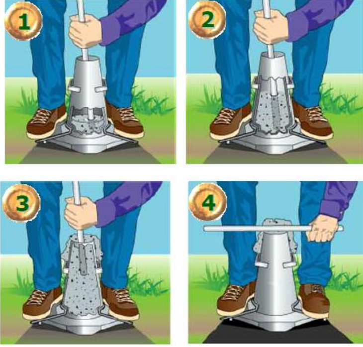
Şekil 1.5: Numuneyi sıkıştırma adımları
