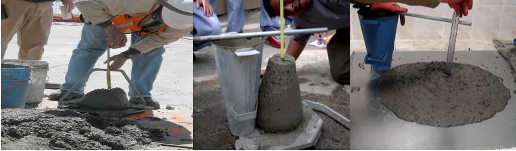
Resim 1.2: Değişik beton çökme değerinin ölçülmesi
