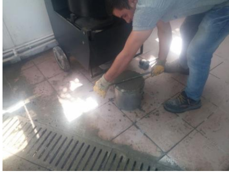
Resim 3.4: Numune yüzeyinin tesviye edilmesi
